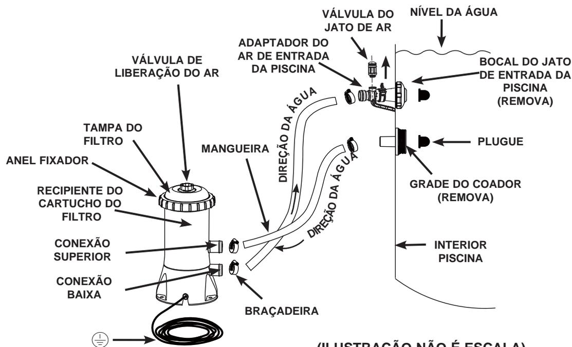
O plugue do cabo de alimentação 220-240 volts da bomba filtro deve ser posicionado com mais de 3,5 m de distância das paredes da piscina. Verifique com as autoridades locais para determinar o padrão adequado e os requisitos para a "instalação elétrica de piscinas e equipamentos". A tabela a seguir é apenas para referência:
